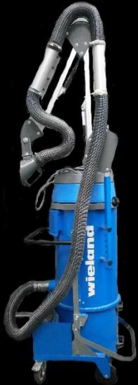
Industriesauger zum Saugen von Stäuben, Spänen, Öl und Wasser. Gesaugt werden können grundsätzlich alle Materialien, welche den Saugschlauch passieren.
