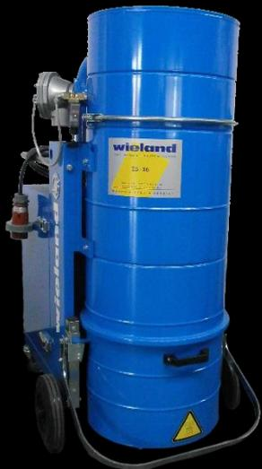
Industriesauger zum Saugen von gesundheitsgefährlichen Stäuben mit allen AGW-Werten mit Rückführung der Reinluft in den Arbeitsraum sowie für einschl. brennbarer Stäuben aller Staubexplosionsklassen in Zone 22.
