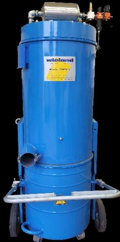
Industriesauger zum Saugen von Stäuben, Spänen, Öl und Wasser. Gesaugt werden können grundsätzlich alle Materialien, welche den Saugschlauch passieren.
