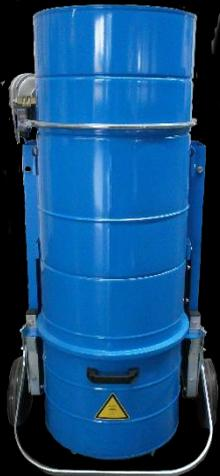
Industriesauger zum Saugen von gesundheitsgefährlichen Stäuben mit allen AGW-Werten mit Rückführung der Reinluft in den Arbeitsraum sowie für einschl. brennbarer Stäuben aller Staubexplosionsklassen in Zone 22.
